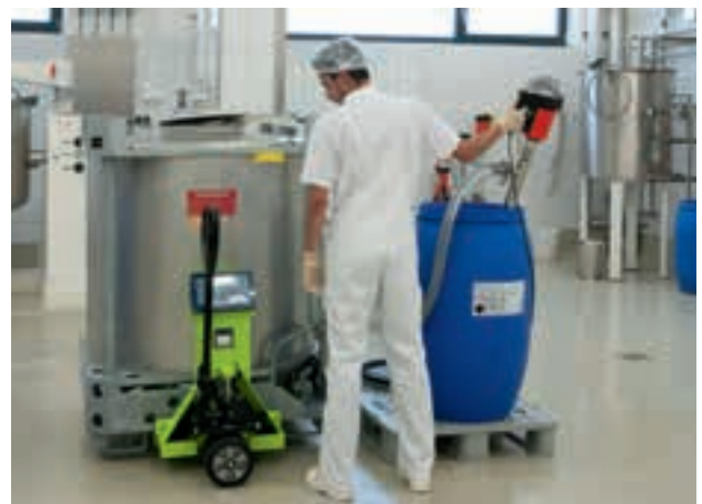
F 560 GS in uso in settore asettico – pompaggio di prodotto di base per creme all'interno di un miscelatore.
